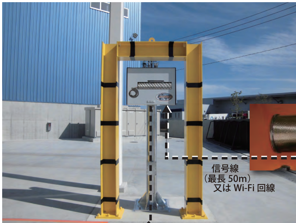
セミポータブル型探知機本体 (通常はハウジング内に収容されています。)
