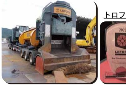
CO<sub>2</sub>削減効果は販売電力使用の2割減となります。移動できることだけが注目されていますが、1台でプレスとギロチンの2役を高速処理する能力について目が向けられていないのは残念なことです。▲例えば、シャーの切断力ですが、メインシリンダーの面積×油圧だけで決まるものではありません。上刃が材料に当たる直前に材料にひび割れを生じさせる機構や上下刃のクリアランス調整を容易にする機構、そして上刃の角度や上刃の下降速度が重要となります。何故なら運動エネルギーは速度の二乗に比例するからです。（ $K=1/2mv^2$ ）▲火力発電が使用する石炭価格は2年間で8倍も高騰したため、電気代はこれから高くなるのは間違いありません。彼等のランニングコストの差は大きくなるでしょう。▲金利2%で7年償却の場合、燃料費や消耗品代も含めた切断ト当たりのコストは1,100円程と安価です。尚、基礎、キュービクルや固定資産税は不要です。
