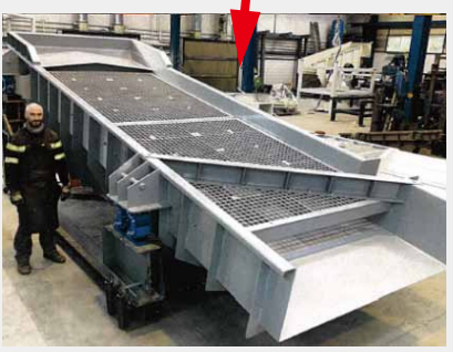
Lefort 社製 LIDEX (ギロチン) の排出口に設置された選別装置
