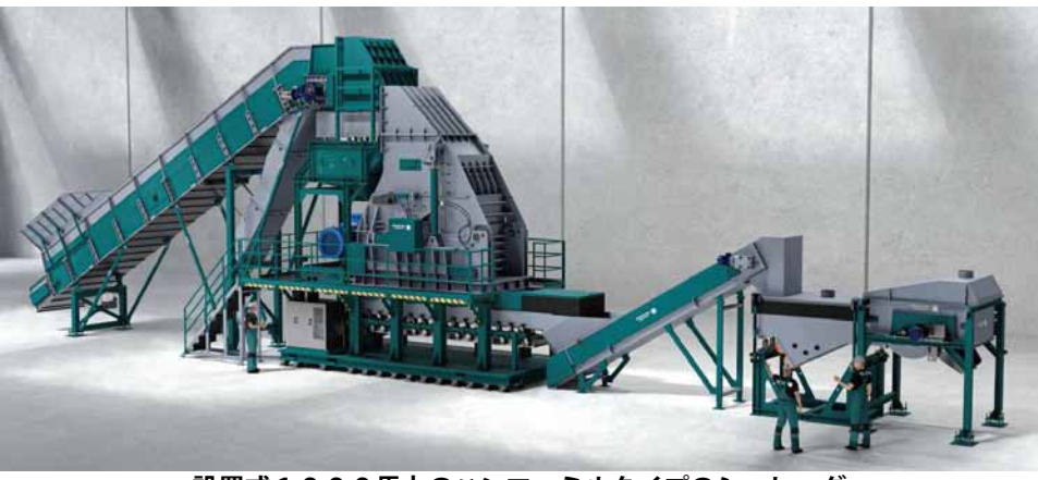
設置式1000馬力のハンマーミルタイプのシュレッダー
