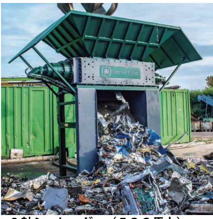
2軸シュレッダー (532馬力) 廃車ガラ、家電の粗破碎に最適です。
